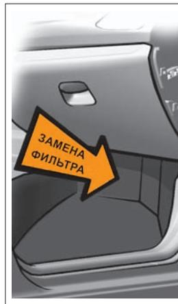
Все версии системы «Классик», «Комфорт» и «Люкс» оснащены салонным противопыльным фильтром, расположенным в модуле отопитель/кондиционер. Сменность фильтра – 30 000 км пробега автомобиля или 1 раз в год, а также раньше, если это вызвано потребностью, выявленной по результатам диагностирования системы вентиляции, эксплуатации автомобиля в особо запыленных условиях.
