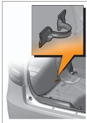
В качестве дополнительного оборудования во всех комплектациях автомобиля над полом багажного отделения предусмотрено крепление сетки за скобы в четырех точках с цельным полотном для предотвращения перемещения груза при движении автомобиля. Для надёжности крепления груза допускается использовать дополнительный неэластичный шнур с зажимом, проходящий по контуру сетки и позволяющий стягивать сетку по периметру.
