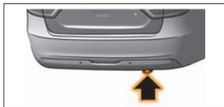
Задняя буксирная проушина приварная, место расположения – справа внизу. Перед буксированием установите ключ в выключателе зажигания в положение «I». Обеспечьте при
