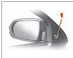
Наружные зеркала заднего вида с ручной регулировкой. Регулировка зеркала производится с помощью рычага 1.
