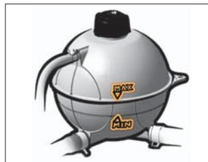
Рис. 5. Расширительный бачок
