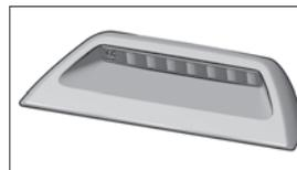
В качестве источников света дополнительного сигнала торможения применены светоизлучающие диоды. В случае выхода из строя 2-х или более источников света дополнительный сигнал торможения заменяется полно-
