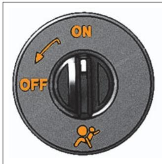
**В варианном исполнении** автомобиль комплектуется выключателем подушки безопасности переднего пассажира, предназначенным для отключения подушки при размещении на переднем сиденье ребенка в **специальном детском кресле**.
